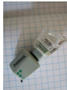
Ce sabot est fixé sur le contour d'oreille de l'enfant. Il faut vérifier que l'enfant le met et qu'il est allumé. (Il peut y en avoir deux)
